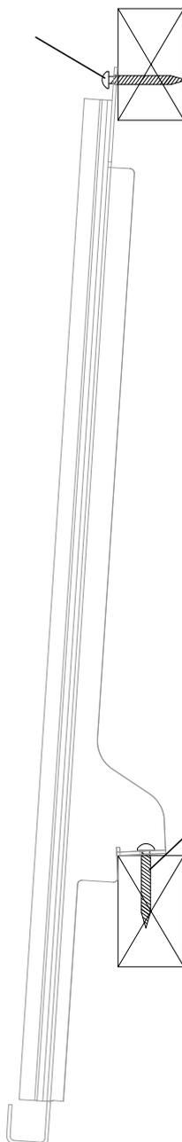
2 pezzi. Viti a testa cilindrica 4 x 35 mm
