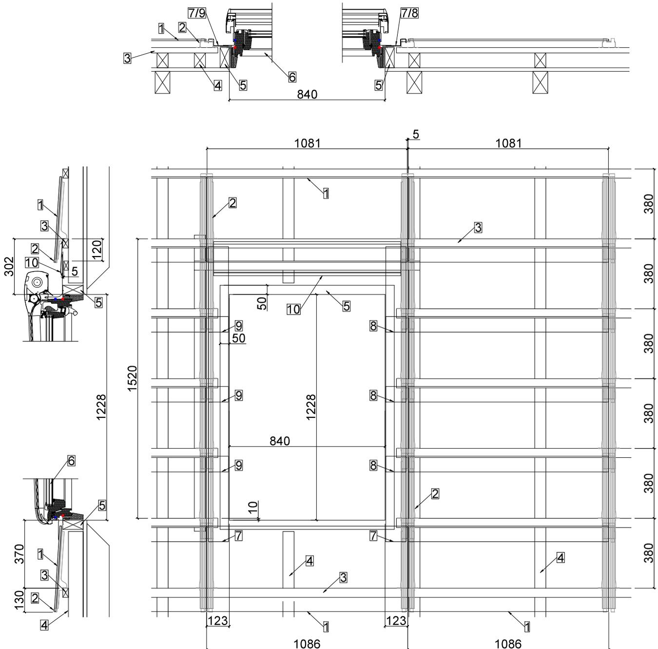
Le finestre per tetti VELUX (di varie dimensioni) possono essere perfettamente combinate con i moduli in ardesia MATCH. Ulteriori informazioni nelle istruzioni di progettazione e installazione separate "Vxx.xx MATCH ardesia con finestre per tetti VELUX".
