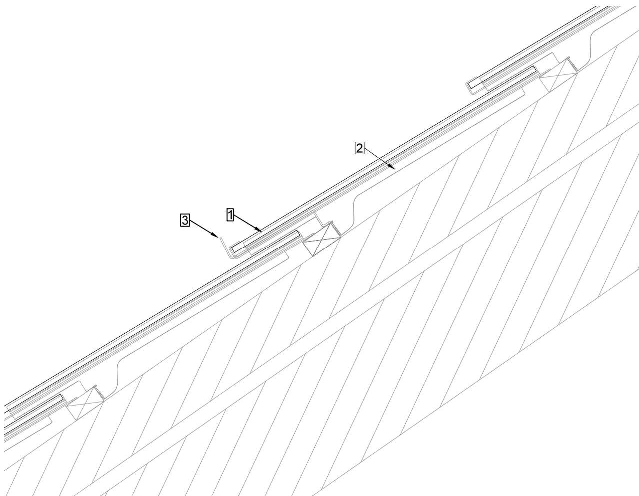
Ogni fermo terminale MATCH Slate è montato sopra un gancio MATCH Slate z / u .
