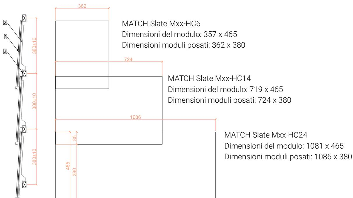
La dimensione moduli dei moduli MATCH Slate è di 380 mm di altezza e può essere regolata di  $\pm 10$  mm.
